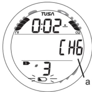
Fig. 4 - LOW BATTERY ALARM
