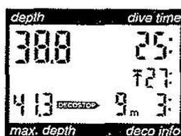
Apparaît alors la flèche **DECO STOP**. Juste à côté de la flèche, apparaît le palier de décompression le plus profond en mètres. A côté du palier de décompression apparaît le temps à passer à ce palier en minutes. L'indication <9 m 3:> signifie donc qu'il faut entamer le premier palier de décompression de 3 minutes à 9 mètres de profondeur.
