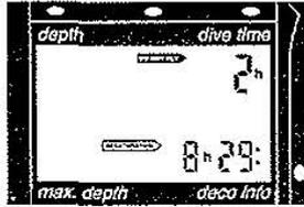
1. On arrive dans le carnet de plongées à partir du mode prêt ou du mode surface en effleurant les contacts B et + . L'affichage <logbook> s'allume. Si l'Aladin® Air X se trouvait auparavant en mode surface, le temps intervalle s'affiche en plus. Avec B et - vous retournez dans le mode prêt ou surface.
