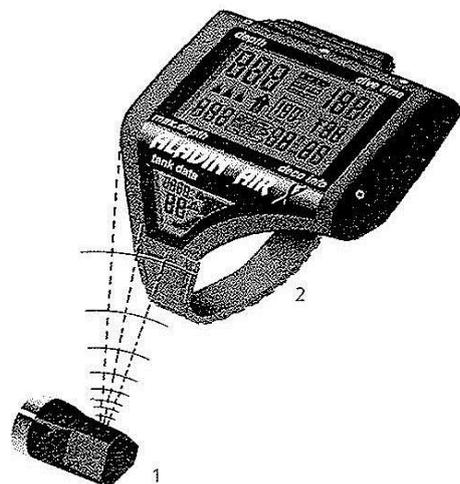
1. L'émetteur est monté sur une sortie "haute pression" du détendeur. Il mesure la pression des bouteilles et transmet ces mesures sans fil à l'ordinateur de plongée où elles sont traitées pour le calcul de la consommation d'air et des données de plongée.
