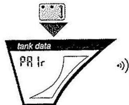
5. Afin de confirmer le couplage, il faut appuyer les touches B et E dans les 5 secondes. Un bip sonore confirme l'entrée et l'indication "PAir" reste à l'écran.
