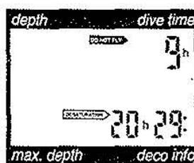
L'Aladin® Air X se trouve en mode surface. La flèche "Désaturation" apparaît; à côté apparaît le temps de désaturation en heures et en minutes. Le temps de désaturation est indiqué jusqu'à la prochaine plongée ou jusqu'à ce qu'il atteigne zéro. Afin d'épargner les piles l'écran s'éteint après trois minutes sans utilisation (mode veille). Les calculs de désaturation se poursuivent cependant.
