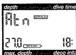
Après la confirmation de l'intervalle de surface (si nécessaire), la courbe de sécurité est indiquée pour des profondeurs de 3 mètres en 3 mètres. Le processus débute à la profondeur à laquelle la courbe de sécurité est pour la première fois inférieure à 99 minutes. Pour chaque pas de 3 mètres, la courbe de sécurité est affichée pendant environ 3 secondes (courbes de sécurité évolutives).
