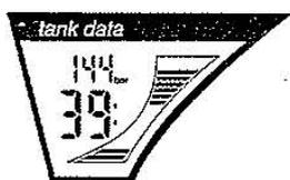
Dans le cadran inférieur la pression des bouteilles est indiquée en bar.
