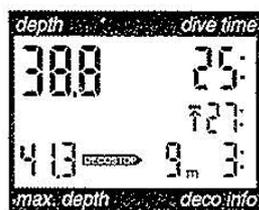
Sitôt que des paliers de décompression sont nécessaires, l'Aladin® Air X indique la durée totale de la remontée. Le temps de remontée jusqu'au palier de décompression le plus profond ainsi que le temps de tous les paliers de décompression y sont compris.
