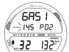
Fig. 30B - SET GAS 1 PO2 ALARM (if Nitrox)
