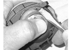
Fig. 117 - TIGHTENING DG03 COVER RING
