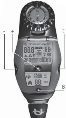
Le Smart COM possède 4 contacts sur le dessus du boîtier (B, E, +, -). Lors des manipulations, il faut mouiller deux doigts puis poser un doigt sur le contact B et l'autre sur l'un des trois autres contacts.
