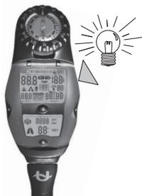
L'écran du Smart COM peut être éclairé en surface comme sous l'eau. Le rétro-éclairage est activé en appuyant sur le côté de l'écran du Smart COM. Il s'éteint automatiquement au bout de 8 secondes, ou du temps choisi avec SmartTRAK. Le rétro-éclairage ne peut être allumé que si l'écran est actif.
