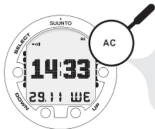
AC APPARAÎT EN HAUT À DROITE DE L'ÉCRAN LORSQUE L'ORDINATEUR DE PLONGÉE EST EN CONTACT AVEC L'EAU. CELA ACTIVE ÉGALEMENT LE MODE PLONGÉE.
