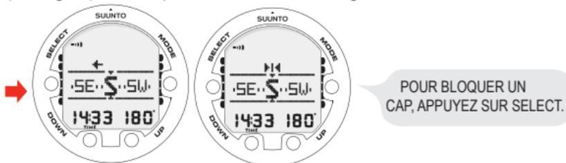
Le Suunto Vyper Air permet également de suivre des schémas de navigation carrés et triangulaires ainsi qu'un cap de retour. Il suffit pour cela de suivre les symboles graphiques visibles au centre de l'affichage de la boussole :
