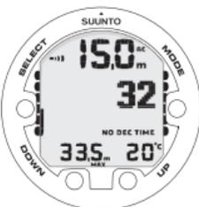
LE BOUTON UP (HAUT) PERMET DE PASSER DU TEMPS D'IMMERSION A LA TEMPERATURE DE L'EAU.
