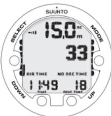
LE BOUTON DOWN (BAS) PERMET D'ALTERNER ENTRE LA PROFONDEUR MAXIMALE, L'HEURE ACTUELLE ET LA PRESSION DE LA BOUTEILLE.
