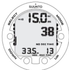
AFFICHAGE DE LA PLONGEE – LA PROFONDEUR ACTUELLE EST DE 15 M, LA LIMITE DU TEMPS DE DECOMPRESSION SANS PALIER EST DE 38 MIN. L'AUTONOMIE D'AIR EST DE 13 MIN.
