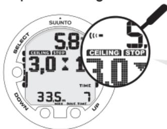
LORSQUE CEILING (PLAFOND) ET STOP (PALIER) SONT AFFICHES, EFFECTUEZ UN PALIER DE SECURITE OBLIGATOIRE D'UNE MINUTE A UNE PROFONDEUR DE 6 A 3 M.
