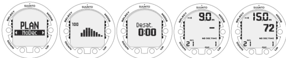
EN ENTRANT DANS LE MODE PLANNODEC L'ECRAN AFFICHE TOUT D'ABORD BRIEVEMENT LA CHARGE DE TISSUS, LE TEMPS DE DESATURATION RESTANT AVANT DE PASSER EN MODE PLAN. UTILISEZ LES BOUTONS UP ET DOWN (HAUT ET BAS) POUR FAIRE DEFILER LES DIFFERENTES LIMITES DE DECOMPRESSION SANS PALIER. LES LIMITES DE DECOMPRESSION SANS PALIER SUPERIEURES A 99 MINUTES SONT REPRESENTES PAR "-".
