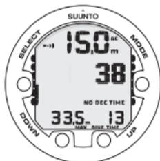
L'évolution de votre consommation en air repose sur une mesure effectuée toutes les secondes sur une période de 30 à 60 secondes. L'autonomie en air chute rapidement si la consommation d'air s'accroît alors qu'elle augmente lentement si la consommation diminue. Ce calcul permet ainsi d'éviter une estimation trop optimiste de l'autonomie en air suite à une baisse momentanée de la consommation.
