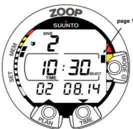
Fig. 4.6. Carnet de plongée, page 1. Défilement des différentes pages d'une plongée.
