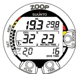
Fig. 3.22. Plongée nitrox. L'O<sub>2</sub> % est réglé à 32 %.
