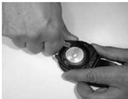
Fig. 5.2. Ouverture de la bague de verrouillage.
