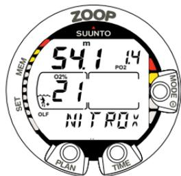
Fig. 3.20. Affichage nitrox. La profondeur maximale basée sur des réglages O<sub>2</sub> % (21 %) et PO<sub>2</sub> (1,4 bar) est de 54,1 m [177 ft].
