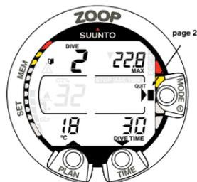
Fig. 4.7. Carnet de plongée, page II. Paramètres principaux de la plongée.
