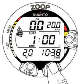
Fig. 3.27. Intervalle surface, heure. En appuyant sur le bouton TIME vous obtenez l'affichage Mode Surface.
