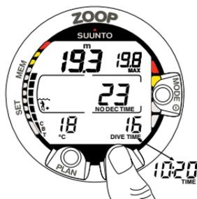
Fig. 3.7. Affichage en plongée. La profondeur est de 19,3 m, le temps de plongée sans palier est de 23 minutes en mode A0/P1. La profondeur maximale de la plongée est de 19,8 m, la température de l'eau est de 18°C, le temps d'immersion est de 16 minutes. En appuyant sur le bouton TIME, l'heure s'affiche pendant 5 secondes.
