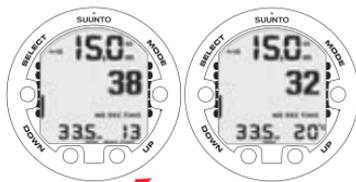
LE BOUTON UP (HAUT) PERMET DE PASSER DU TEMPS D'IMMERSION A LA TEMPERATURE DE L'EAU.
