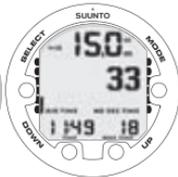
LE BOUTON DOWN (BAS) PERMET DE PASSER DE LA PROFONDEUR MAXIMALE A L'HEURE ACTUELLE.
