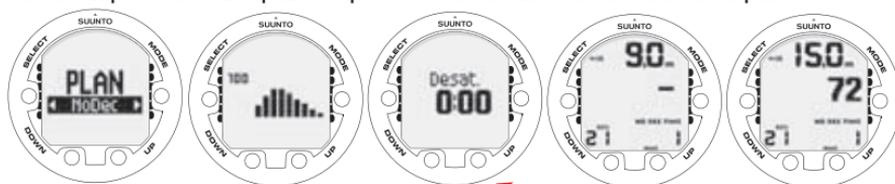
EN ENTRANT DANS LE MODE MEMPLAN L'ECRAN AFFICHE TOUT D'ABORD BRIEVIEMENT LA CHARGE DE TISSU, LE TEMPS DE DESATURATION RESTANT AVANT DE PASSER EN MODE PLAN. UTILISEZ LES BOUTONS UP ET DOWN (HAUT ET BAS) POUR FAIRE DEFILER LES DIFFERENTES LIMITES DE DECOMPRESSION SANS PALIER. LES LIMITES DE DECOMPRESSION SANS PALIER SUPERIEURES A 99 MINUTES SONT REPRESENTES PAR "...".
