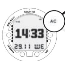
AC APPARAÎT EN HAUT À DROITE DE L'ÉCRAN LORSQUE L'ORDINATEUR DE PLONGÉE EST EN CONTACT AVEC L'EAU. CELA ACTIVE ÉGALEMENT LE MODE PLONGÉE.
