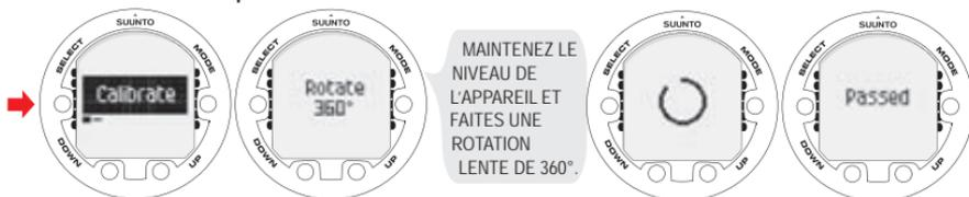
Si le calibrage échoue plusieurs fois de suite, il se peut que vous vous trouvez dans une zone à proximité de sources magnétiques, telles que de gros objets métalliques, des lignes électriques ou des appareils électriques. Dans ce cas, changez d'endroit et essayez de calibrer de nouveau votre compas. Si le calibrage échoue toujours, contactez un centre de service agréé Suunto.
