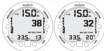
LE BOUTON UP PERMET D'ALTERNER ENTRE LE TEMPS D'IMMERSION ET LA TEMPÉRATURE DE L'EAU.
