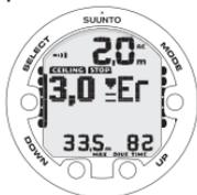
PLONGÉE AVEC PALIERS DE DÉCOMPRESSION, AU-DESSUS DU PLAFOND. NOTEZ LA FLÈCHE POINTÉE VERS LE BAS, L'AVERTISSEMENT ER ET L'ALERTE. VOUS DEVEZ IMMÉDIATEMENT (DANS LES 3 MINUTES) DESCENDRE AU OU SOUS LE PLAFOND.
