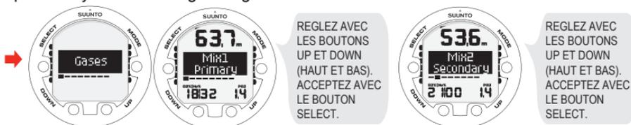
En mode MIXED GAS (Mélange de gaz), l'ordinateur de plongée affiche également la profondeur maximale autorisée pour le mélange utilisé.
