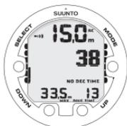
AFFICHAGE DE LA PLONGÉE - LA PROFONDEUR ACTUELLE EST DE 15 M, LA PROFONDEUR MAXIMALE DE LA PLONGÉE EST DE 33,5 M ET LA LIMITE DU TEMPS DE DÉCOMPRESSION SANS PALIER EST DE 13 MIN.
