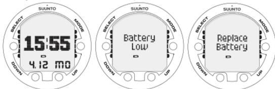
Si ce symbole apparaît en mode Surface ou si l'affichage est faible ou peu visible, c'est que la pile n'est plus assez puissante pour faire fonctionner l'ordinateur de plongée et il est nécessaire de la remplacer.
