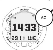
AC APPARAÎT EN HAUT À DROITE DE L'ÉCRAN LORSQUE L'ORDINATEUR DE PLONGÉE EST EN CONTACT AVEC L'EAU.
