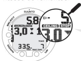
LORSQUE CEILING (PLAFOND) ET STOP (PALIER) SONT AFFICHÉS, EFFECTUEZ UN PALIER DE SECURITE OBLIGATOIRE D'UNE MINUTE A UNE PROFONDEUR DE 6 A 3 M.
