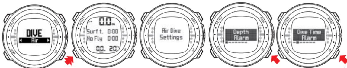
UTILISER LES BOUTONS UP ET DOWN (HAUT ET BAS) POUR PASSER D'UN REGLAGE DE PLONGEE A L'AUTRE.
