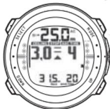
UNE FLECHE POINTEE VERS LE HAUT, UN TEMPS ASC CLIGNOTANT ET UNE ALARME VOUS AVERTISSENT DE REMONTER. UN TEMPS DE REMONTEE TOTAL MINIMUM COMPRENANT UN PALIER DE SECURITE EST DE 4 MINUTES PLAFOND A 3 M.
