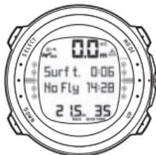
CELA FAIT 6 MINUTES QUE VOUS AVEZ FAIT SURFACE APRES UNE PLONGEE DE 35 MINUTES. LA PROFONDEUR MAXIMALE ETAIT DE 21,5 M. LA PROFONDEUR ACTUELLE EST DE 0,0 M. LE SYMBOLE DE L'AVION ET L'INTERDICTION DE VOL INDIQUENT QUE VOUS NE DEVEZ PAS VOUS DEPLACER EN AVION PENDANT 14 HEURES ET 28 MINUTES. LE SYMBOLE ATTENTION DU PLONGEUR INDIQUE QUE VOUS DEVEZ PROLONGER VOTRE TEMPS D'INTERVALLE SURFACE.
