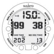
AFFICHAGE DE LA PLONGEE – LA PROFONDEUR ACTUELLE EST DE 15 M, LA LIMITE DU TEMPS DE DECOMPRESSION SANS PALIER EST DE 38 MIN. LE TEMPS DE PLONGEE ECOULE EST DE 13 MIN. L'AUTONOMIE EN AIR EST DE 99 MINUTES ET LA PRESSION D'AIR DE 202 BARS.
