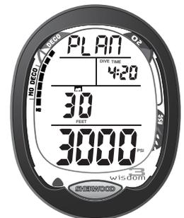
Fig. 17 - Air Mode Plan
