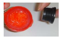
Serrez le capuchon à la main à l'aide de la pièce de monnaie. Un serrage excessif peut déformer le joint torique et placer un point de stress sur le boîtier.
