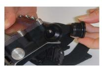
Tirez délicatement le support de pile. Afin d'éviter rebonds et frottements, il est monté serré. Un pic dentaire ou un trombone sera sans doute nécessaire pour l'extraire.
