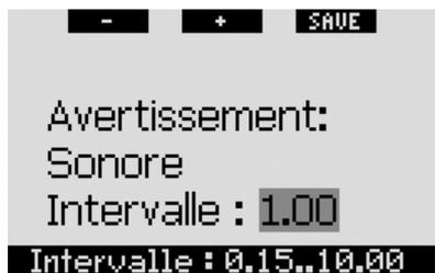
Galileo vous permet de fixer un avertissement d'intervalle de temps de plongée, afin que vous puissiez suivre le temps que vous passez sous l'eau sans devoir regarder l'affichage. L'avertissement peut être réglé par pas de 15 secondes, avec un intervalle maximal de 10 minutes. A chaque multiple de l'intervalle fixé, Galileo va émettre une séquence sonore de 3 secondes, constituée de trois signaux courts.
