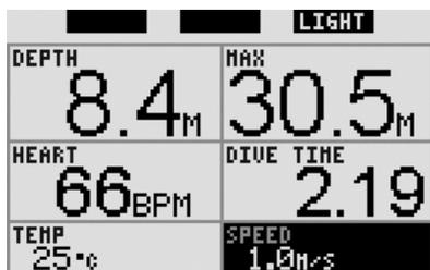
La vitesse de remontée lors d'une plongée en apnée est une moyenne sur une période de 4 secondes, elle est affichée en m/s ou en pieds/s. L'alarme de vitesse de remontée peut être réglée entre 0,1 et 5,0 /s par pas de 0,1 m/s. Si, lors d'une remontée, la vitesse est supérieure à la valeur fixée, un son continu se fait entendre, et la vitesse (SPEED) est affichée en couleurs inversées (blanc sur fond noir).
