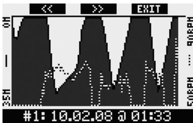
En **appuyant sur >>**, le profil de profondeur et le profil de température sont affichés simultanément. Si le cardio-fréquencemètre\* a été mis sur **ON**, alors en **appuyant sur >>** vous voyez le profil
