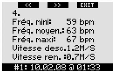
**Appuyer sur >>** une fois de plus vous permet d'afficher des informations détaillées pour chaque plongée, en commençant avec le compteur séquentiel qui identifie la plongée, suivi de la fréquence cardiaque\* minimale, moyenne et maximale, des vitesses de descente et de remontée maximale et minimale.
