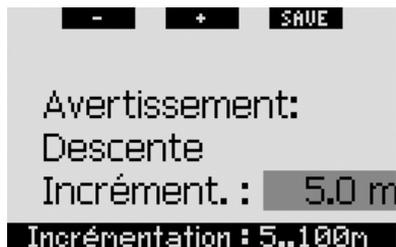
Galileo vous permet de fixer un avertissement d'incrémentation de profondeur, afin que lors de votre descente (**WAY DOWN**), remontée (**WAY UP**), ou les deux (**BOTH**), vous puissiez suivre votre progression sans regarder l'affichage. L'avertissement peut être réglé par pas de 1 m, entre 5 m et 300 m. A chaque multiple de l'intervalle fixé, Galileo va émettre une séquence sonore de 2 secondes, constituée de deux signaux courts.
