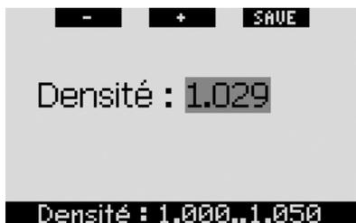
Il y a une relation directe entre le poids d'une colonne d'eau et la pression qu'elle exerce, et le poids est donné par la profondeur multipliée par la densité de l'eau. Par
