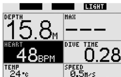
Galileo peut déclencher une alarme si votre fréquence cardiaque\* chute en dessous d'un niveau fixé. Cette alarme (FC basse) peut être réglée entre 35 et 100 battements par minute, par pas d'un battement par minute. Si votre fréquence cardiaque\*
