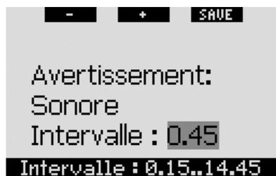
De façon analogue à l'avertissement d'intervalle de temps de plongée, cet avertissement vous permet de suivre le temps passé en surface. L'avertissement peut être réglé par pas de 15 secondes, avec un intervalle maximal de 14 minutes et 45 secondes. A chaque multiple de l'intervalle fixé, Galileo va émettre une séquence sonore de 3 secondes, constituée de trois signaux courts.
