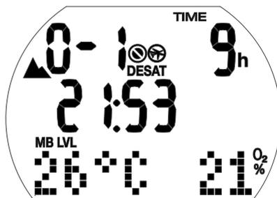
À partir de l'affichage de l'heure du jour, vous pouvez vérifier le temps de désaturation\* par une pression prolongée sur le bouton de droite. Le temps de désaturation est déterminé soit par la toxicité de l'oxygène, soit par la
