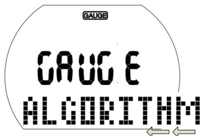
1. Depuis l'affichage de plongée, une pression prolongée sur le bouton de droite fait apparaître le menu « GAS » (gaz). Appuyez 4 fois sur le bouton de droite, et le menu « ALGORITHM » (algorithme) s'affiche. Si l'Aladin Sport affiche « OFF », le mode profondimètre ne peut pas être
