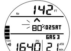
Fig. 66 – AVERTISSEMENT O<sub>2</sub> (pendant le signal sonore, mode plongée sans décompression)
