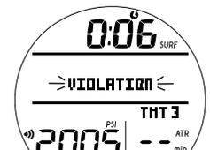
Fig. 62 - ÉCRAN PRINCIPAL D'INFRACTION AVEC LIMITATION AU MODE PROFONDIMÈTRE (après moins de 10 min en surface)
