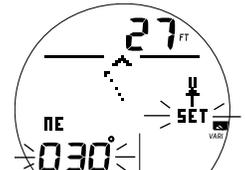
Fig. 119 – RÉGLAGE D'UN CAP DE RÉFÉRENCE (rotation jusqu'au cap souhaité)
