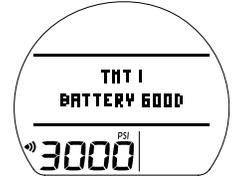
Fig. 2 – ÉTAT DE LA PILE DE L'ÉMETTEUR
