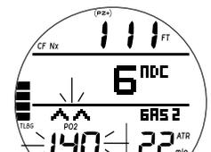
Fig. 64 - ALARME PO<sub>2</sub> (pendant signal sonore)
