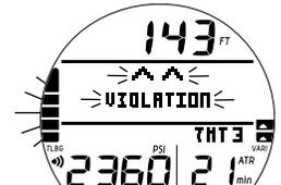
Fig. 60 - ÉCRAN PRINCIPAL D'INFRACTION AVEC LIMITATION AU MODE PROFONDIMÈTRE (activé, pendant signal sonore)
