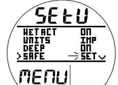
Fig. 26B - RÉGLAGE D'UN PALIER DE SÉCURITÉ (pour accéder au réglage de la profondeur et du temps)
