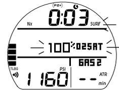
Fig. 69 – ALARME DE HAUT NIVEAU DE O<sub>2</sub> (en surface < 10 min)
