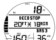
Fig. 65 - ALARME PO<sub>2</sub> (pendant le signal sonore en mode décompression)
