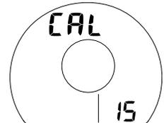
Fig. 123 – PROGRESSION DE LA CALIBRATION (un cercle se forme pendant la rotation)
