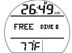
Fig. 93 – ÉCRAN PRINCIPAL DU MODE SURFACE FREE (pas encore de plongée)
