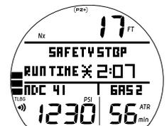
Fig. 50B – ÉCRAN PRINCIPAL DE PALIER DE SÉCURITÉ (réglage sur minuteur avant la plongée)
