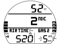
Fig. 43 – ÉCRAN PRINCIPAL DE PLONGÉE SANS DÉCOMPRESSION (pendant l'alarme de temps d'air restant)
