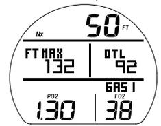
Fig. 11C – SÉQUENCE DE PLANIFICATION PRÉ-PLONGÉE (temps contrôlés par O<sub>2</sub>)
