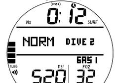
Fig. 6B – ÉCRAN PRINCIPAL DU MODE SURFACE NORM (après la plongée au Nitrox n°2)
