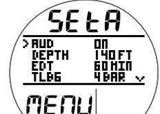
Fig. 24A - MENU SET A (déplacement dans les sélections)
