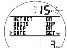
Fig. 26C - RÉGLAGE D'UN PALIER DE SÉCURITÉ (profondeur, temps)
