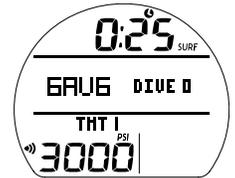
Fig. 80 – ÉCRAN PRINCIPAL MODE SURFACE GAUG (pas encore de plongée effectuée)
