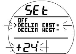
Fig. 126 – RÉGLAGE DE LA DÉCLINAISON
