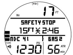
Fig. 50A - ÉCRAN PRINCIPAL DE PALIER DE SÉCURITÉ (réglage sur profondeur/temps avant la plongée)
