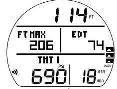
Fig. 90B – ÉCRAN PRINCIPAL DU MODE PLONGÉE GAUG (si sélectionné)
