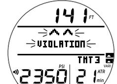
Fig. 61 - ÉCRAN PRINCIPAL D'INFRACTION AVEC LIMITATION AU MODE PROFONDIMÈTRE (après signal sonore)
