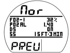
Fig. 22 – PRÉVISUALISATION (réglages sélectionnés)
