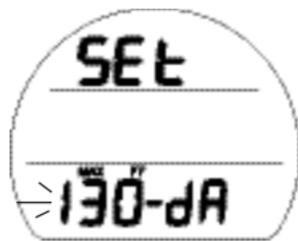
Fig. 21 - RÉGLAGE DE L'ALARME DE PROFONDEUR
