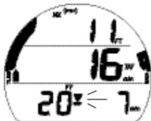
Fig. 66 - ÉCRAN PRINCIPAL D'INFRACTION PROVISOIRE (après signal sonore)
