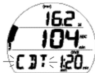
Fig. 105 - ALARME DU MINUTEUR DE COMPTE A REBOURS
