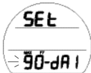
Fig. 99B - RÉGLAGE DE L'ALARME DE PROFONDEUR DA1
