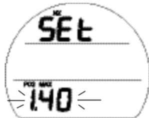
Fig. 25 - RÉGLAGE DE L'ALARME PO2
