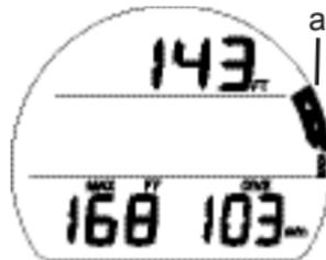
Fig. 48 - ÉCRAN PRINCIPAL DU MODE PLONGÉE (remontée normale)
