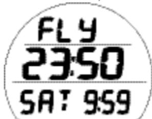
Fig. 7B - ÉCRAN INTERDICTION DE VOL/DÉSATURATION (10 min après la plongée)
