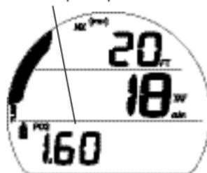
Fig. 74 - ALARME PO2 (pendant une phase de décompression)
