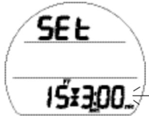
Fig. 30C - RÉGLAGE D'UN PALIER DE SÉCURITÉ TEMPS/PROFONDEUR
