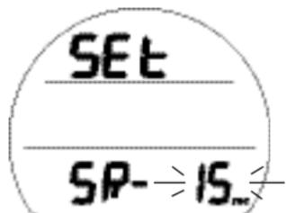
Fig. 34 - RÉGLAGE DU TAUX D'ÉCHANTILLONNAGE
