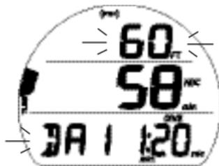
Fig. 107 - ALARME DE PROFONDEUR
