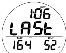
Fig. 79 - ÉCRAN SECONDAIRE ALT 1 DU MODE SURFACE GAUG (données de la dernière plongée)
