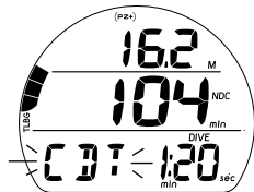
Fig. 100 - ALARME DU MINUTEUR DE COMPTE A REBOURS
