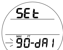
Fig. 94B - RÉGLAGE DE L'ALARME DE PROFONDEUR DA1
