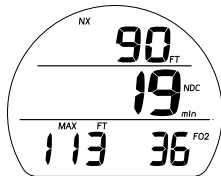
Fig. 9A - SÉQUENCE DE PLANIFICATION PRÉ- PLONGÉE
