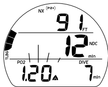
Fig. 72 - MISE EN GARDE PO2 (pendant signal sonore)
