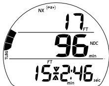
Fig. 59 - ÉCRAN PRINCIPAL DE PALIER DE SÉCURITÉ (réglé sur On. Profondeur/ temps définis)
