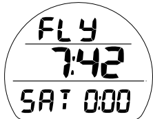
Fig. 7C - ÉCRAN INTERDICTION DE VOL/DÉSATURATION (temps de désaturation expiré)
