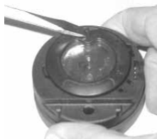
Fig. 109 - BAGUE DE FIXATION DU COUVERCLE
