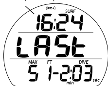
Fig. 86 - ÉCRAN SECONDAIRE ALT 1 DU MODE SURFACE FREE (données de la dernière plongée)
