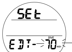
Fig. 22 - RÉGLAGE DE L'ALARME DE TEMPS DE PLONGÉE ÉCOULÉ
