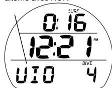
Fig. 71 - ÉCRAN PRINCIPAL SURFACE D'INFRACTION AVEC LIMITATION AU MODE PROFONDIMÈTRE
