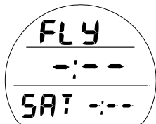
Fig. 7A - ÉCRAN INTERDICTION DE VOL/DÉSATURATION (aucune plongée effectuée depuis l'activation)
