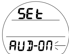
Fig. 20 - RÉGLAGE DU SIGNAL SONORE D'ALARME
