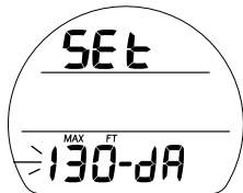
Fig. 21 - RÉGLAGE DE L'ALARME DE PROFONDEUR
