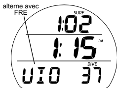
Fig. 105 - INFRACTION EN MODE FREE (après une minute en surface)
