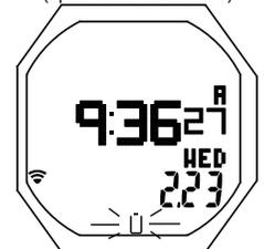
Fig. 4 - MODE MONTRE (alarme de pile faible)
