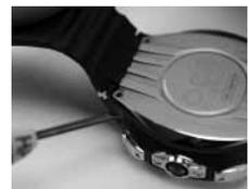
Fig. 166A - POUR DESSERRER LE COUVERCLE DE LA PILE
