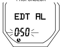
Fig. 42 - RÉGLAGE DE L'ALARME DE TEMPS DE PLONGÉE ÉCOULÉ
