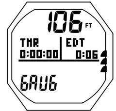
Fig. 110 - ÉCRAN PRINCIPAL PLONGÉE GAUG (minuteur réglé sur ON)
