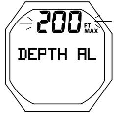
Fig. 41 - RÉGLAGE DE L'ALARME DE PROFONDEUR
