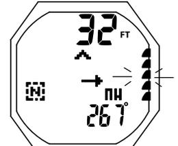
Fig. 159 - ALARME DE REMONTÉE
