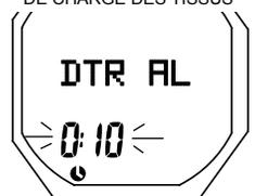
Fig. 44 - RÉGLAGE DE L'ALARME DE TEMPS DE PLONGÉE RESTANT
