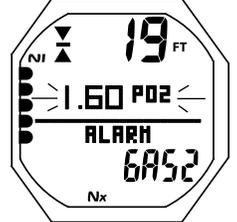
Fig. 96 - ALARME DE HAUT NIVEAU DE PO<sub>2</sub> (100%) (pendant la décompression)
