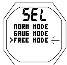
Fig. 134 - SÉLECTION DU MODE DE PLONGÉE
