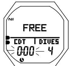
Fig. 129 - ÉCRAN PRINCIPAL SURFACE (pendant l'alarme du minuteur de compte à rebours)
