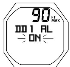
Fig. 131 - RÉGLAGE DE L'ALARME FREE DE PROFONDEUR DE DESCENTE DD 1
