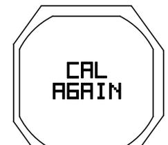
Fig. 156 - CAL AGAIN (= ÉCHEC DU CALIBRAGE)
