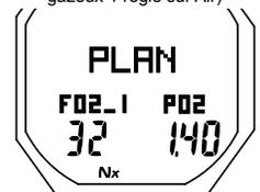
Fig. 31B - ÉCRAN D'ACCÈS AU MODE PLAN (mélange gazeux 1 réglé sur Nitrox)
