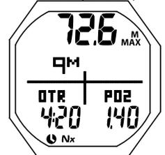
Fig. 32B - SÉQUENCE DE PLANIFICATION PRÉ-PLONGÉE (plongée contrôlée par l'oxygène)
