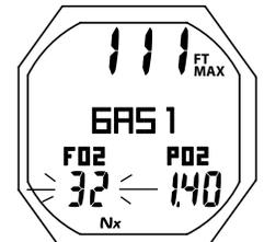
Fig. 37B - RÉGLAGE FO<sub>2</sub> DU MÉLANGE GAZEUX 1 (Nitrox)
