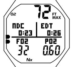
Fig. 76 - ÉCRAN SECONDAIRE DE PALIER DE SÉCURITÉ
