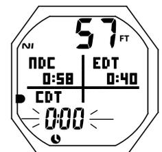
Fig. 138 - ALARME DE MINUTEUR DE COMPTE À REBOURS EN MODE PLONGÉE
