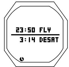
Fig. 29 - FLY/DESAT (INTERDICTION DE VOL/ DÉSATURATION) (10 min après une plongée)
