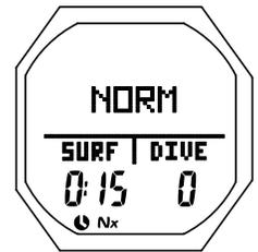
Fig. 24 - ÉCRAN PRINCIPAL SURFACE NORM (aucune plongée effectuée jusque là)
