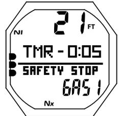
Fig. 75 - ÉCRAN PRINCIPAL DE PALIER DE SÉCURITÉ (défini pour une utilisation avec minuteur)
