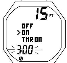
Fig. 48B - RÉGLAGE D'UN PALIER DE SÉCURITÉ (TEMPS ET PROFONDEUR)
