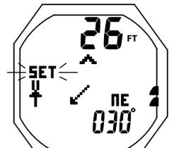
Fig. 151 - RÉGLAGE D'UN CAP DE RÉFÉRENCE (rotation jusqu'au cap souhaité)
