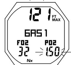
Fig. 38 - RÉGLAGE DE L'ALARME PO<sub>2</sub> DU MÉLANGE GAZEUX 1
