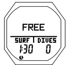
Fig. 124A - ÉCRAN PRINCIPAL SURFACE FREE (pas encore de plongée)
