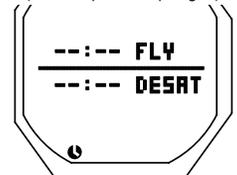
Fig. 30 - FLY/DESAT (INTERDICTION DE VOL/ DÉSATURATION) (< 10 min après une plongée)
