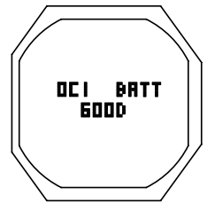
Fig. 1A - ÉTAT DE LA PILE DE L'OC1
