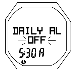
Fig. 17 - ÉTAT DE L'ALARME JOURNALIÈRE (lors de l'accès)
