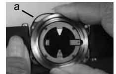
Fig. 164 – JOINT TORIQUE DE LA PILE
