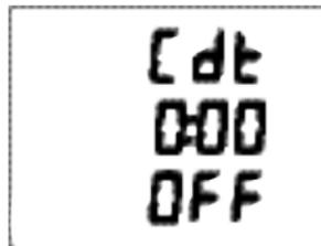
Fig. 98B - Minuteur OFF (pas de temps réglé)
