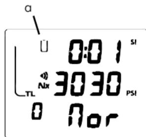
Fig. 2 - Alarme pile faible
