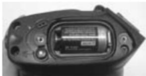
Fig. 116 - Joint et pile installés
