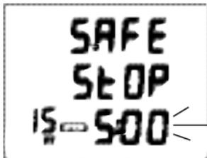
Fig. 34 - Réglage du palier de sécurité
