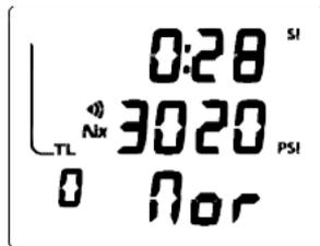
Fig. 15A - Affichage principal surface NOR (pas encore de plongée)
