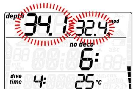
L'alarme continue jusqu'à ce que le plongeur ait suffisamment remonté pour que la  $ppO_2$  revienne dans les limites programmées.
