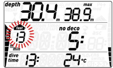
Dans ce cas, si le plongeur essaie de refaire une plongée après être arrivé en surface, le Nemo Wide ne fonctionnera que comme profondimètre et chronomètre (mode profondimètre), et il affichera
