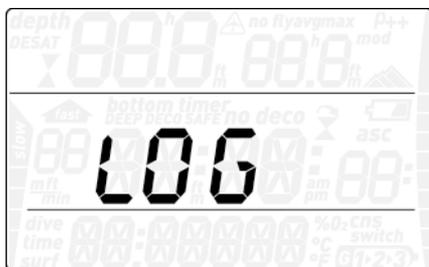
Le Nemo Wide peut enregistrer les profils d'environ 35 heures de plongée, avec une fréquence d'échantillonnage de 5 secondes. Ces informations peuvent être envoyées grâce au clip USB optionnel vers un PC à l'aide du logiciel Dive Organizer, ou vers un Mac grâce au logiciel Divers' Diary. De plus, le Nemo Wide peut afficher la plus grande partie des informations directement sur son propre écran.
