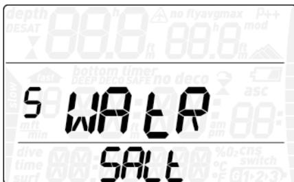
Vous pouvez calibrer l'ordinateur sur **FRESH** (eau douce) ou **SALT** (eau salée), en fonction de l'endroit où vous avez l'intention de plonger. Régler sur un type d'eau erroné génère une erreur de la mesure de la profondeur d'environ 3 % (c'est-à-dire qu'à une profondeur de 30 m/100 pieds, un ordinateur réglé sur
