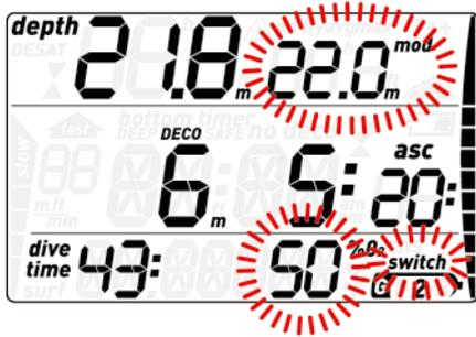
Appuyez sur le bouton **enter** ou appuyez et maintenez-le pour confirmer le passage à G2 : la concentration en oxygène du réglage s'affichera fixement dans le coin en bas à droite de l'écran, et sous 20 secondes la durée de la remontée est mise à jour afin de refléter la plus haute concentration en oxygène du gaz qui est respiré.
