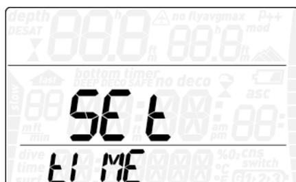
Appuyez sur le bouton **enter** pour entrer dans un menu, appuyez sur le bouton **+** ou **-** pour faire défiler les options possibles vers le haut ou le bas, ou pour augmenter ou diminuer la valeur d'un réglage. Appuyer sur le bouton **enter** confirme la modification du réglage. Appuyez sur le bouton **esc** pour remonter d'un niveau dans l'arborescence du menu.
