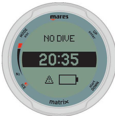
Le niveau de charge exact de la batterie peut être visualisé en bas de l'affichage, en faisant défiler les informations à l'aide du bouton en bas à droite (voir section 1.4).
