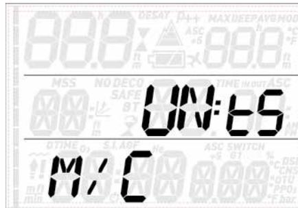
Vous pouvez choisir entre les unités métriques (profondeur en mètres, températures en °C) et impériales. (profondeur en pieds, température en °F).
