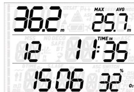
Appuyez sur « ENTER » pour visualiser la page suivante du carnet de plongée, qui affiche l'intervalle de surface avant la plongée alternant avec le temps en plongée et la **CNS** (alternant entre les valeurs de début et les valeurs de fin) sur la ligne du bas. Dans le cas où plus d'un gaz aurait été utilisé lors de la plongée, les informations concernant **G2** et **G3** si applicables s'affichent en alternance avec celles de G1 sur la première page.
