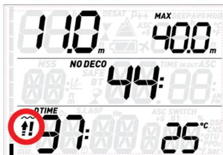
Dans ce cas, si le plongeur essaie de refaire une plongée après être arrivé en surface, le Quad ne fonctionnera que comme profondimètre et chronomètre (mode profondimètre), et il affichera **!!** sur l'écran tout au long de la plongée.
