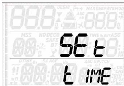
Ce menu vous permet de régler l'heure et la date. Appuyez sur le bouton « ENTER », et **24h** ou **AMPM** se mettront à clignoter. Appuyez sur le bouton « UP » ou « DOWN » pour faire défiler les deux options et/ou appuyez sur « ENTER » pour confirmer, et continuez pour régler l'heure, les minutes et la date.
