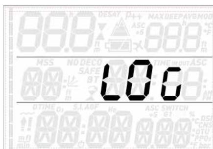
Le Quad peut enregistrer les profils d'environ 35 heures de plongée, avec une fréquence d'échantillonnage de 5 secondes. Ces informations peuvent être envoyées grâce au clip USB optionnel vers un PC à l'aide du logiciel Dive Organizer, ou vers un Mac grâce au logiciel Divers' Diary. De plus, le Quad peut afficher la plus grande partie des informations directement sur son propre écran.
