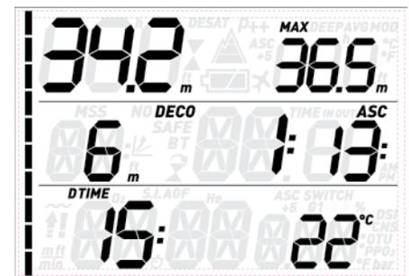
En appuyant sur l'un des boutons du haut, vous pouvez modifier les informations qui s'affichent sur la ligne du haut. À chaque pression de bouton, l'écran fait défiler la profondeur maximale, la profondeur moyenne, la MOD (Nitrox seulement), le palier profond (si activé et s'il est validé par calcul) et un champ vide.
