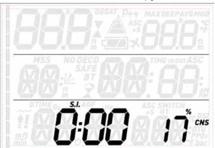
Utilisez les boutons « UP » et « DOWN » pour augmenter/diminuer la profondeur par incréments de 3 m (dans la limite de la MOD de G1) et pour visualiser le temps sans décompression qui en découle. Pressez sur le bouton « ENTER » pour entrer la planification de la décompression: le Quad ajoute une minute au temps sans décompression et affiche l'obligation de décompression correspondante. Utilisez maintenant les boutons « ENTER » et « DOWN » pour modifier le temps de plongée, et voir de quelle
