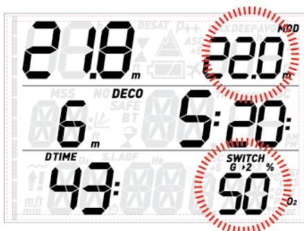
Appuyez longuement sur l'un des boutons du bas pour confirmer le passage à G2 : la concentration en oxygène du réglage
