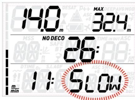
Si la vitesse de remontée est supérieure à 12 m/min à une profondeur plus importante que 12 m, le message **!!** (remontée trop rapide) clignote également. Si une vitesse supérieure à 12 m/min est maintenue sur les deux tiers ou plus de la profondeur à laquelle l'alarme a été déclenchée, le Quad considère qu'il s'agit d'une violation et affiche le **!!** de façon fixe.
