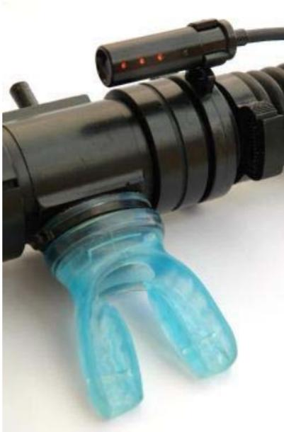
Optional kann unser kompaktes hwHUD ebenfalls an den heinrichs weikamp ppO2 Monitor angeschlossen werden. Dazu werden im Sensorkopf vier Datenleitungen mit dem hwHUD-Kabel verbunden (es sind zwei Durchführungen im Kopf nötig).
