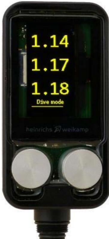
**EINSCHALTEN:** Zweimal innerhalb einer Sekunde die Taste ENTER betätigen.
