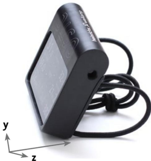
L'OSTC 4 dispose d'une boussole électronique à compensation d'inclinaison. Comme toutes les boussoles électroniques, elle doit être calibrée avant usage. La calibration permet de compenser les aberrations potentiellement causées par la batterie.
