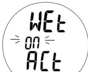
Fig. 27 – RÉGLAGE DE L'ACTIVATION À L'EAU
