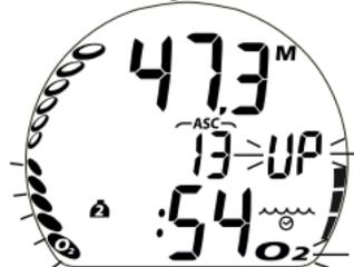
Fig. 71 – ALARME DE O<sub>2</sub> ÉLEVÉ (pendant signal sonore)
