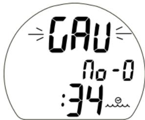
Fig. 76 – ÉCRAN PRINCIPAL DU MODE PROFONDIMÈTRE EN SURFACE (GAUG)
