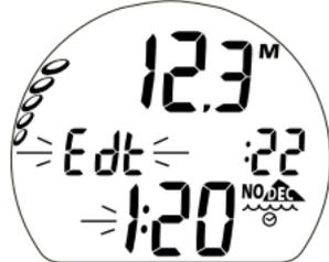
Fig. 93 - ALARME DE TEMPS DE PLONGÉE ÉCOULÉ EDT - MODE LIBRE FREE
