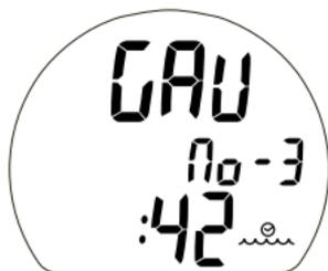
Fig. 77 – ÉCRAN PRINCIPAL DU MODE PROFONDIMÈTRE EN SURFACE (GAUG)
