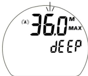
Fig. 21 – RÉGLAGE PROFONDEUR
