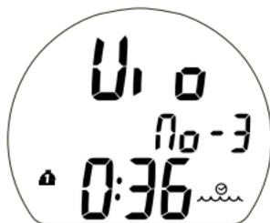
Fig. 66 – ÉCRAN PRINCIPAL DE VIOLATION AVEC LIMITATION AU MODE PROFONDIMÈTRE (en surface)
