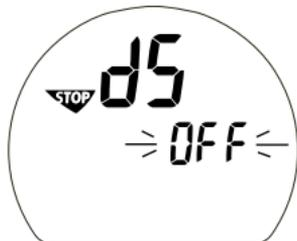
Fig. 29 – RÉGLAGE DES PALIERS DE DÉCOMPRESSION (DS)
