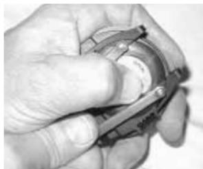
Fig. 109 – MISE EN PLACE DU CERCLAGE (autre possibilité)
