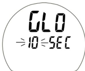
Fig. 32 – RÉGLAGE DU RÉTROÉCLAIRAGE (GLO)
