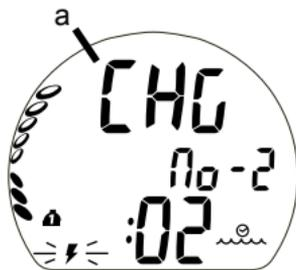
Fig. 4 – ALARME DE PILE
