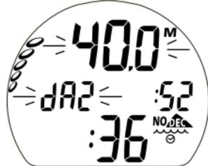
Fig. 92 - ALARME DE PROFONDEUR DA - MODE LIBRE FREE
