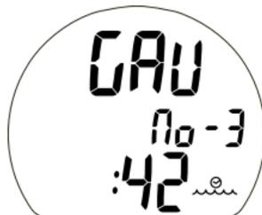
Fig. 1B – MODE PROFONDIMÈTRE (GAUG)
